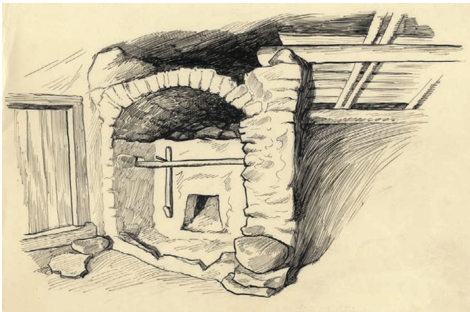
Joonis 2. Rehetoa kummiga kaetud kerisahi. Viru-Jaagupi khk Leo küla Abrami talu. I. Linnati joonis 1937. EJ 84:62.
